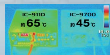
上記写真は15分間連続送信した際の背面シャシ温度の比較です。IC-911Dが65度まで発熱しているのに対し、IC-9700は45度までしか温度が上昇していません。
