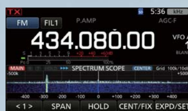
リアルタイムスペクトラムスコープ &ウォーターフォール表示例
